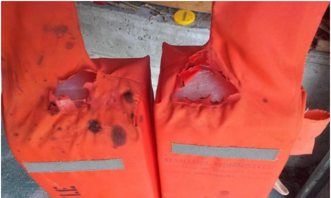
Brennmerke og oljesøl er godt synleg på redningsvesten.
