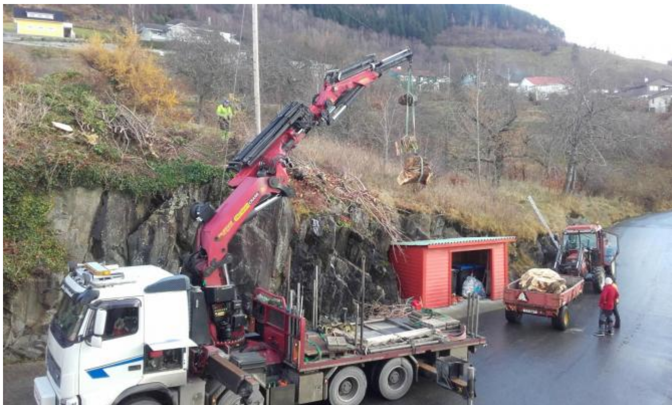
Bit for bit vert det, som stod att av treet, løfta med kranbil ned på traktorhengaren. John Guddal styrer spakane.
