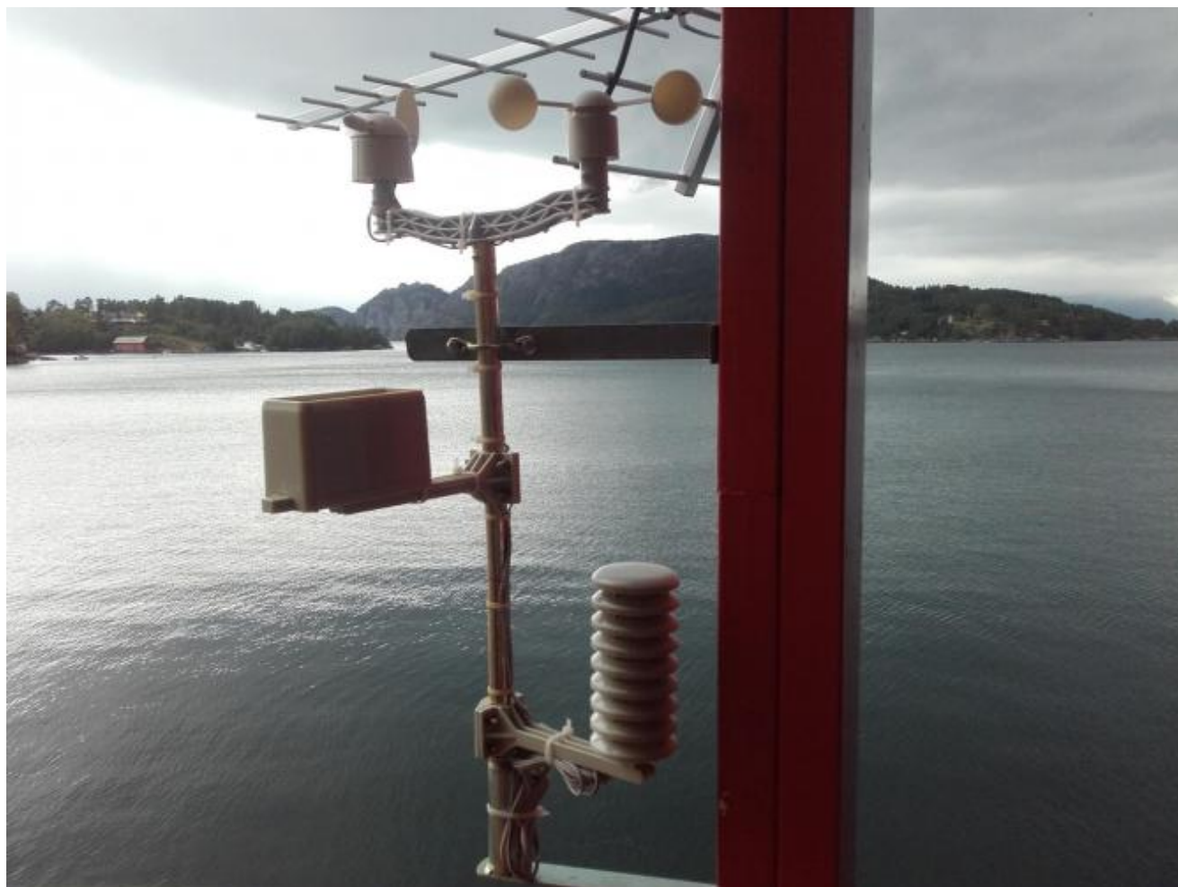
Bilete syner målestasjonen til Oskar Langballe i Beinavikjo, som måler nedbør, temperatur og vindstyrke. TV antennen er ikkje ein del av stasjonen.
