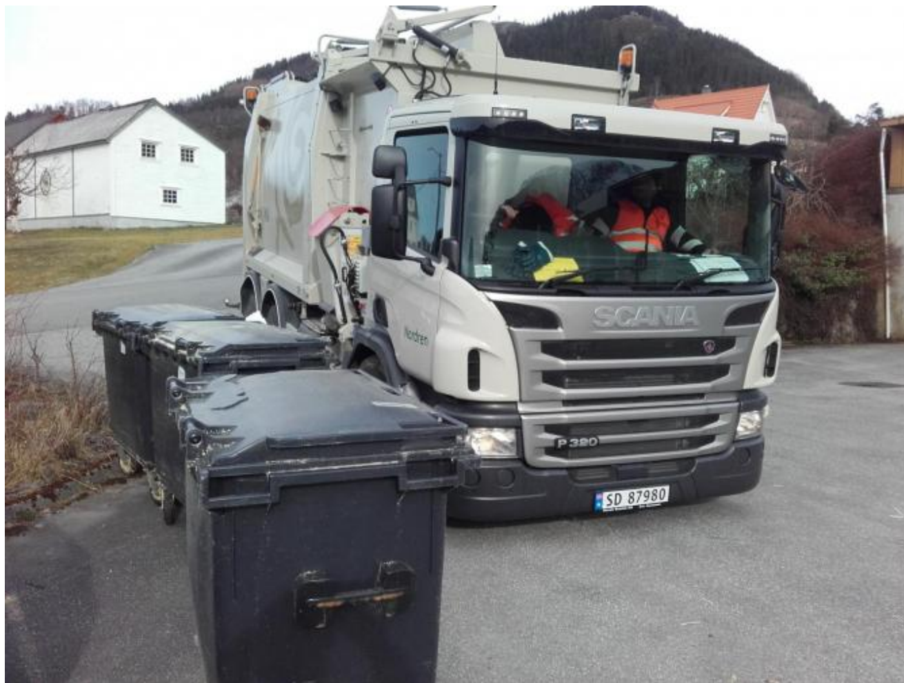
Den nye renovasjonsbilen hentar restavfall og bio ved Kvinnherad Vekstbedrift. Bilen har sidelastar og to kammer.
