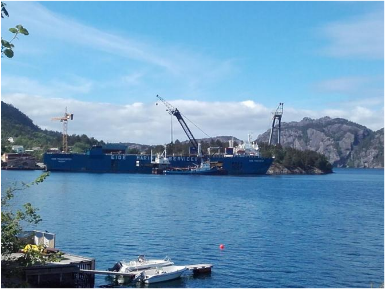
Tysdag var det to kranskip på plass i Uskedalen. EIDE LIFT 6 hadde oppdraget med sjøsetjing og snuing av skipsskrog for Fitjar Mek.
