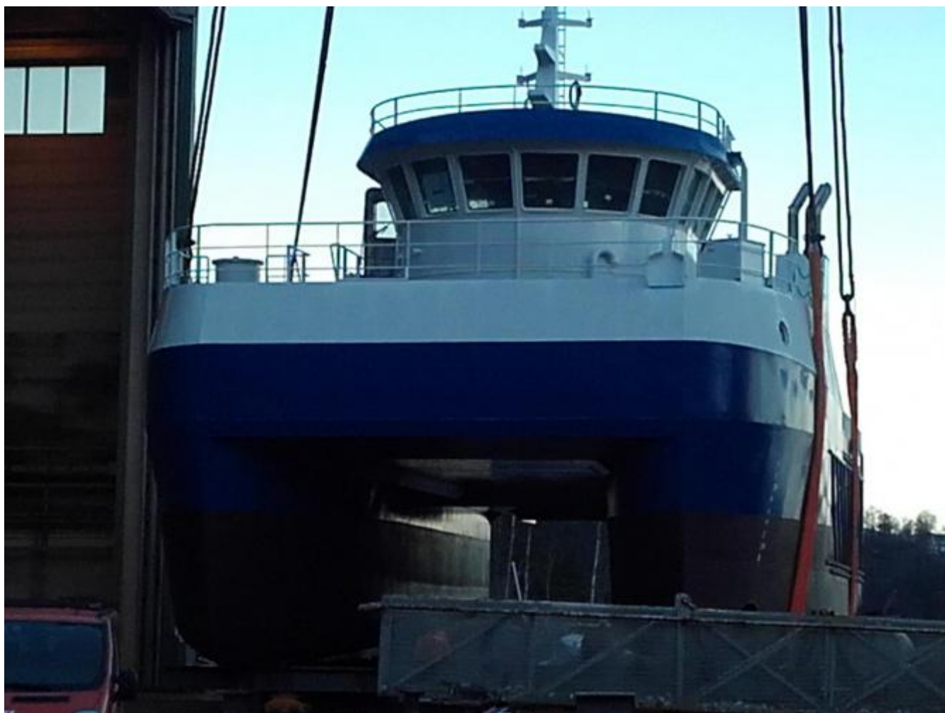
Arbeidsbåten er stroppa og klar for sjøsetjing.
