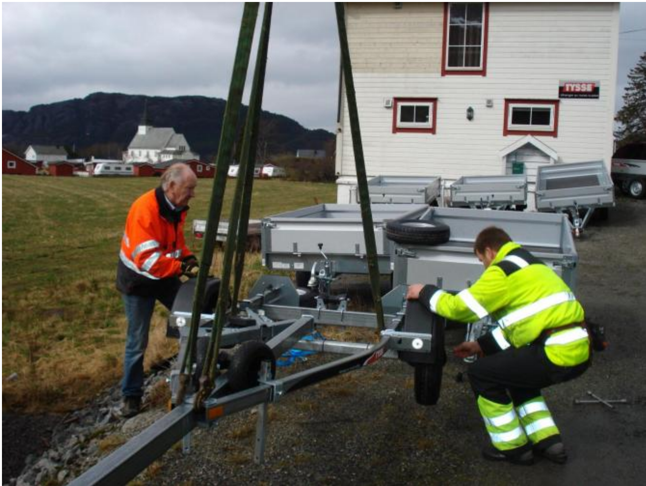
Før hengarane landa på oppstillingsplassen vart det monterte hjul på dei.
