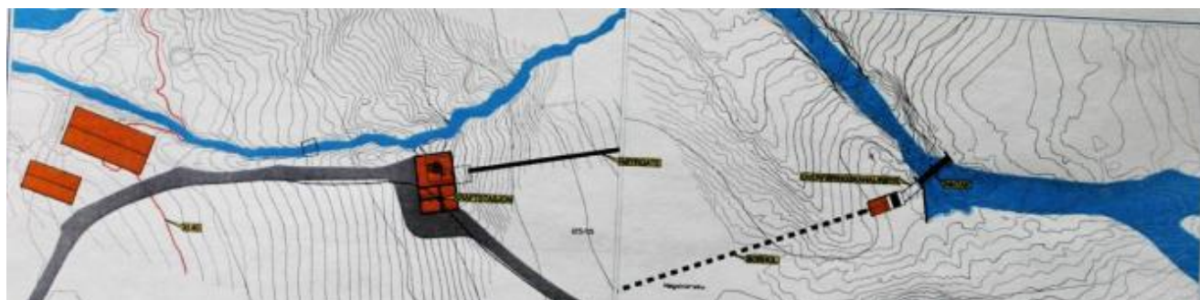
Andre installasjonar i kraftverket med kraftstasjonen til venstre og inntaket til høgre
