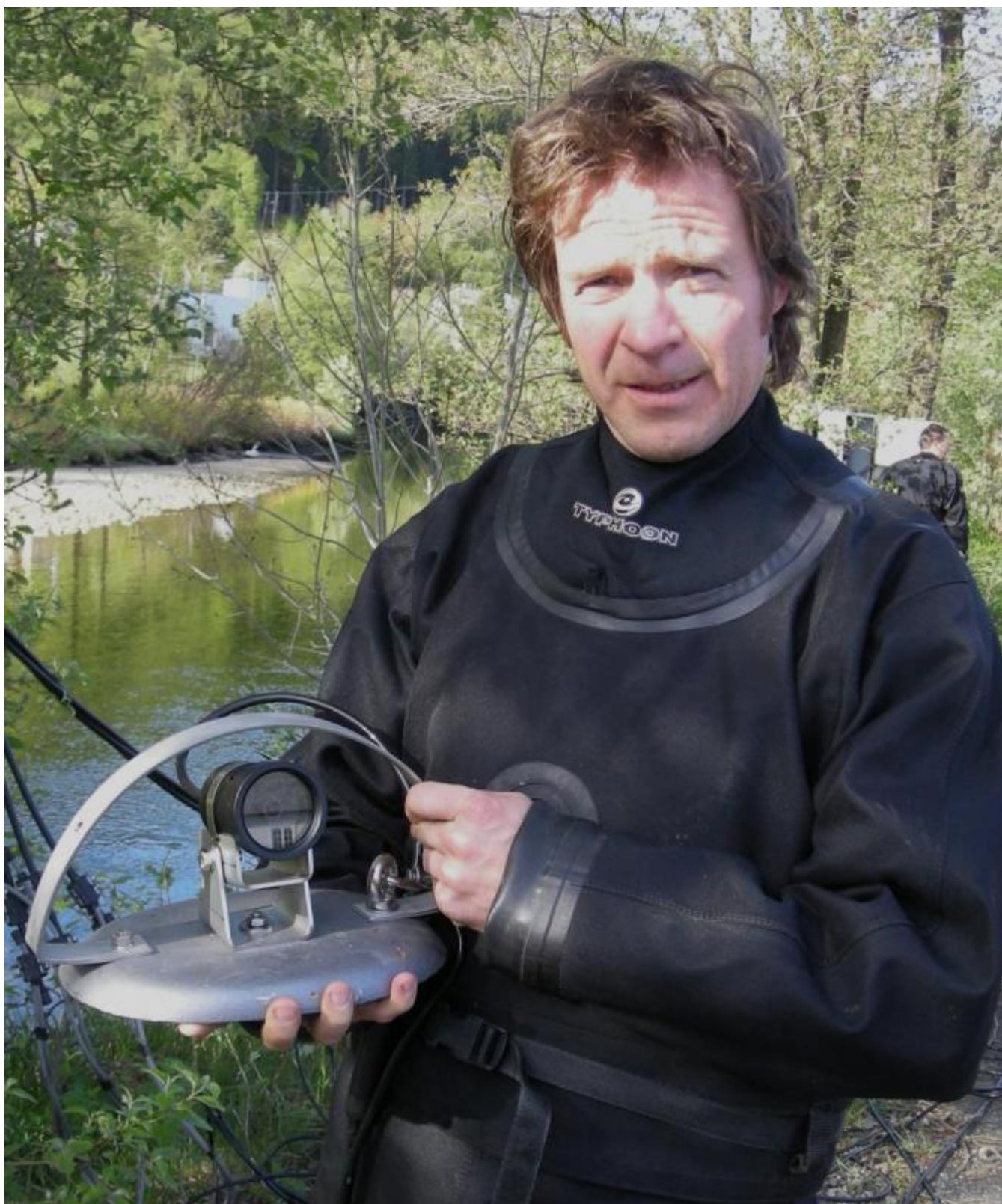
Slik ser eit overvakningskamera for lakselus ut. (Foto: Ola Matti Mathisen)
